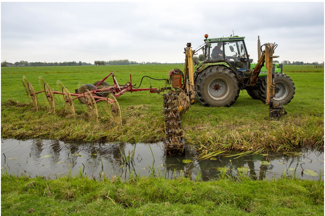
Figuur 5. Bij het schonen met de ecoreiniger wordt de oevervegetatie met behulp van een maaibalk gemaaid en circa 3 meter uit de kant gewierst. Zegveld.
