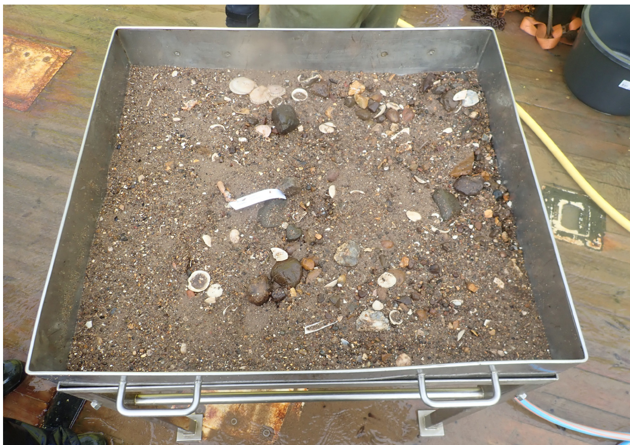
Fig. 2. Overzicht van het bodemsediment nadat het met een Hamon happer van de waterbodem is gevist en op een zeefplaat is gestort. Hier is goed te zien dat het sediment bestaat uit grof zand en stenen met wat schelpengruis.
