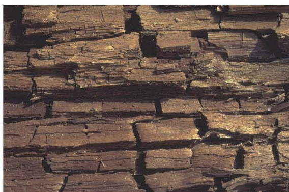
Foto 2: De typische verschijningsvorm van bruinrot. Let op de kleur, en het rechthoekige patroon van barsten. Bron: Natural Resources Canada website.
