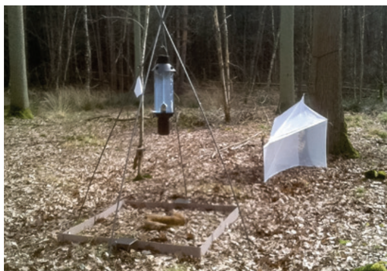
▲ Proefopstelling bos met (1) in het midden het reekadaver (2) rechts (wit): malaiseval; (3) boven het kadaver: raamval; (4) rond het kadaver in een rechthoek: rechtopstaande geleiders (grijs) die naar 2 bodemvallen leiden (links en rechts met vierkante afdakjes tegen de regen).
