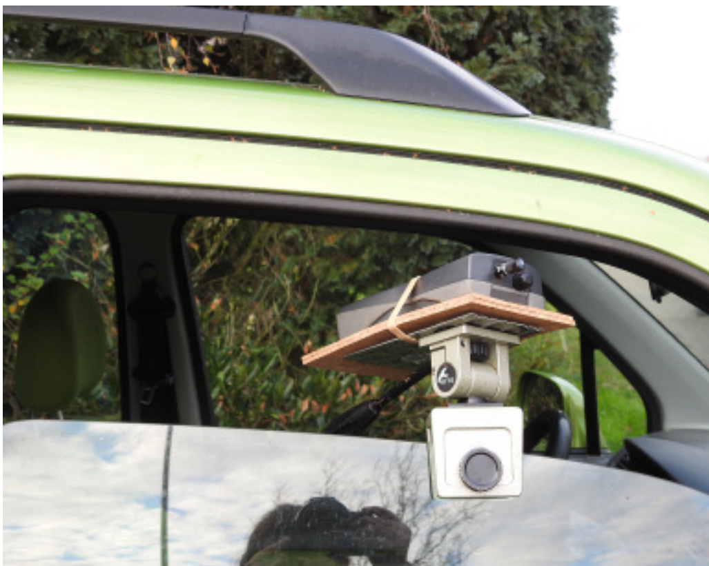
Vleermuisgeluiden oppikken met een automatische batdetector op een vast traject. Foto Bernadette van Noort
