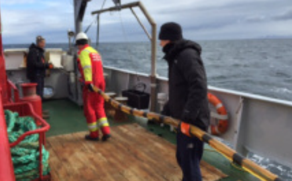
Het hydrofoon-array Delphinus wordt over boord gezet achter het schip. Met deze slang met onderwater-microfoons aan een lange kabel wordt onder water geluisterd naar de aanwezigheid en positie van de walvissen. Foto Frans-Peter Lam
