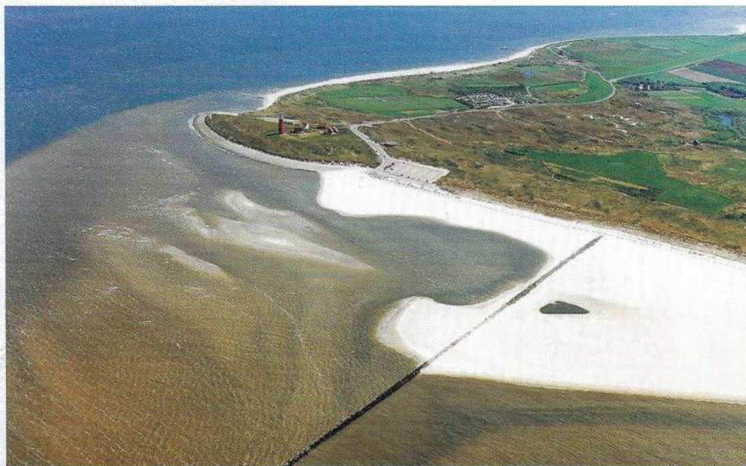
Op de noordwestpunt van Texel was ernstige kustafslag. Een dam in zee heeft binnen enkele jaren de oplossing gebracht (foto: Paul Paris).
