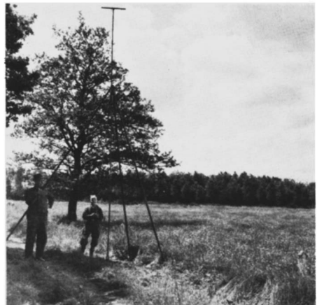
fig. 4: Boring LP 63, boormeester en ass. boormeester hebben zojuist het boorgereedschap getakeld.
