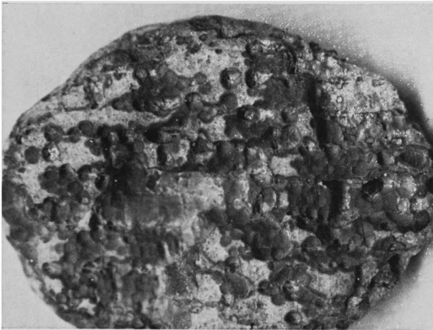
Zelfde exemplaar met 'beschadigde' onderzijde. Het caverneuze karakter is waarschijnlijk te wijten aan oplossing van kalk of kiezelzuur. 1,3x.
