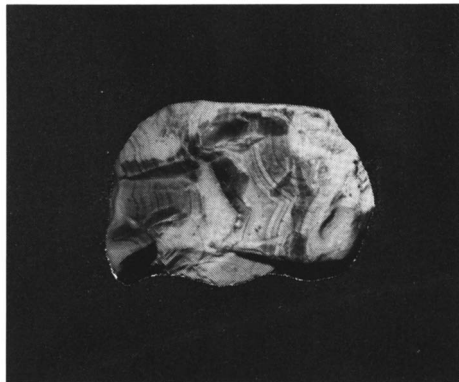
Bild 4. Unbehandelte Bruchfläche eines Achats
