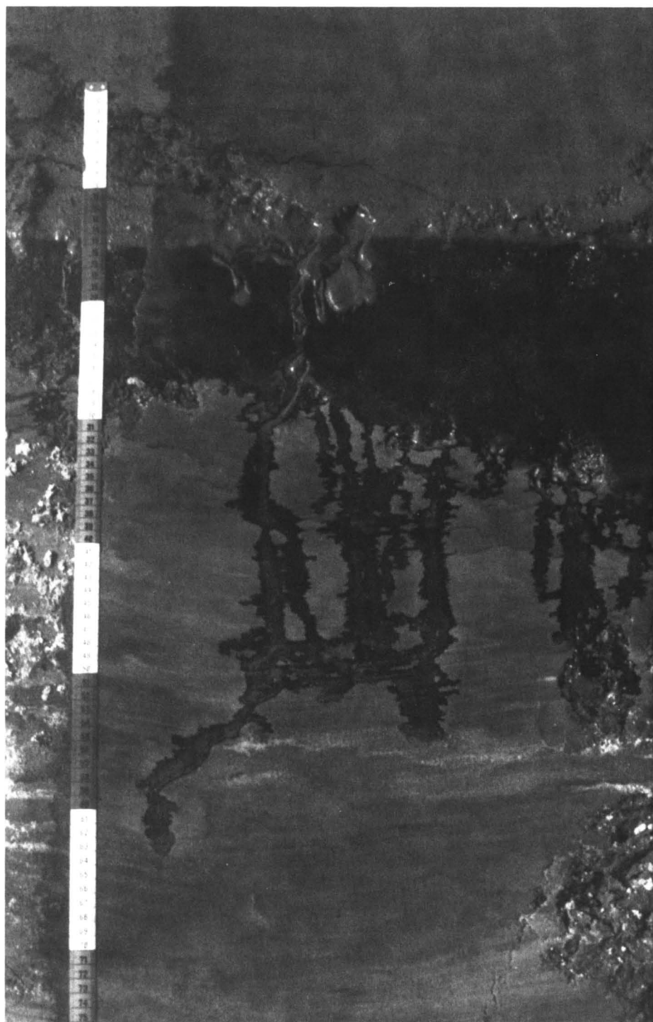
Figuur 8. Water treedt over waterhard uit de profielwand. De door preferente stroombaantjes mee-gevoerde humus wordt op het onderliggende dekzand afgezet.
