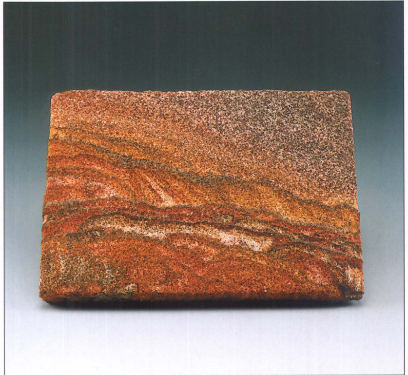
Rode zandsteen. De roodkleuring wordt veroorzaakt door ijzeroxidehuidjes rond de kwartskorrels. Kanab, Utah, V.S. Foto J. van Delft.
