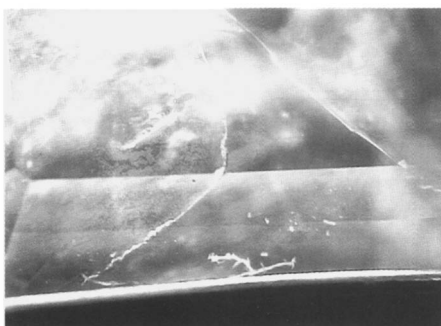
Afb. 4. Dit breukje in een smaragd was in eerste instantie onzichtbaar gemaakt door behandeling met olie. Door uitdroging van de olie is de breuk echter voor een belangrijk deel weer zichtbaar. Deze smaragd heeft dus een nieuwe 'onderhoudsbeurt' nodig.
