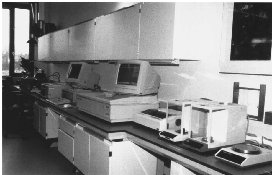
Afb. 1. Overzicht laboratorium: geavanceerde behandelingen van edelstenen kunnen worden vastgesteld met high-tech apparatuur als UV-Visible en FTIR-spectrometers.
