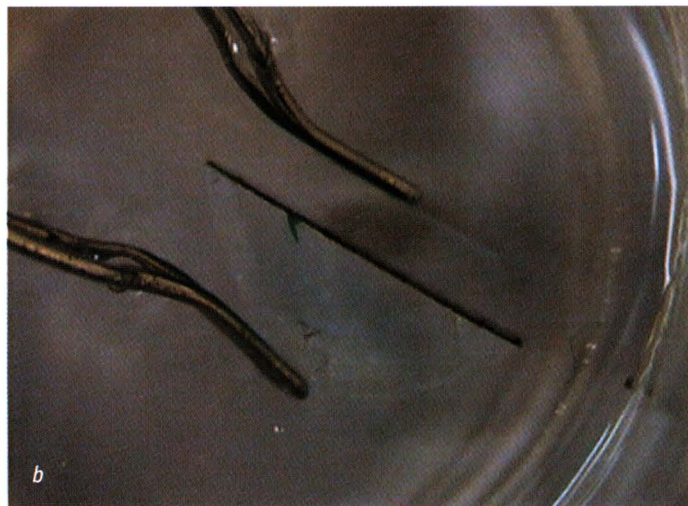
Afb. 9. Zogenaamde 'soudé-smaragd' lijkt op het eerste gezicht precies op smaragd (a), maar als de steen vanaf de zijkant in een vloeistof bekeken wordt, tegen een witte achtergrond, blijkt dat hij bestaat uit twee kleurloze delen (berghkristal) die met een groene kitlaag aan elkaar vastzitten (b).
