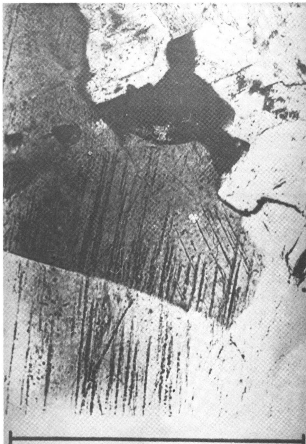
Figuur 10 Slijpplaatje van een breksie van een kwarts-hoornblend gneis van Brent krater afkomstig 529,5 m diepte. De kwarts vertoont duidelijk evenwijdige lamellen als stille getuigen van het passeren van een hevig schokfront. De streep is 1/2 \text{ mm} .
