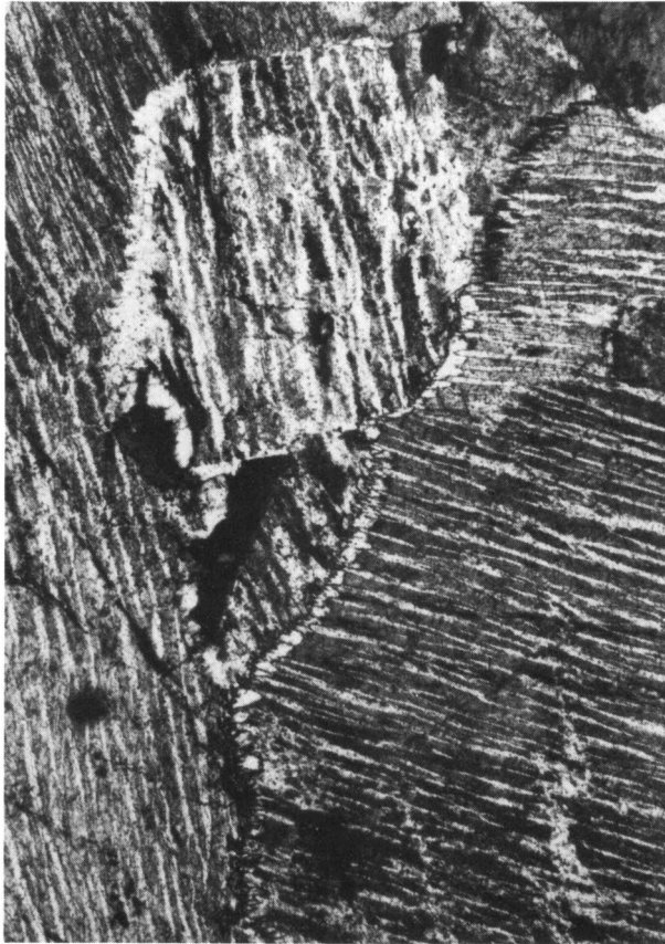
foto 1. Alkaliveldspaatgraniet (ekeriet), als H. Slijpplaat, 24 x, gekruiste nicols. Perthitische alkaliveldspaat in detail. Wit (ook aan de kristalbegrenzingsen): albiet. Donkerder: kaliveldspaat.
