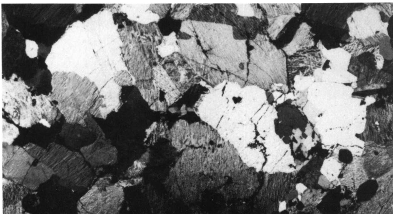
Foto H. Alkaliveldspaatgraniet (ekeriet), Oslogebied, slijpplaat, 7 x, gekruiste nicols. In de grijze partijen is de perthitische alkaliveldspaat te zien: lichte albitlamellen in de donkerder kaliveldspaat. Er is enige blauwgroene hoornblende (arfvedsoniet). Zie kl.-foto 11.
