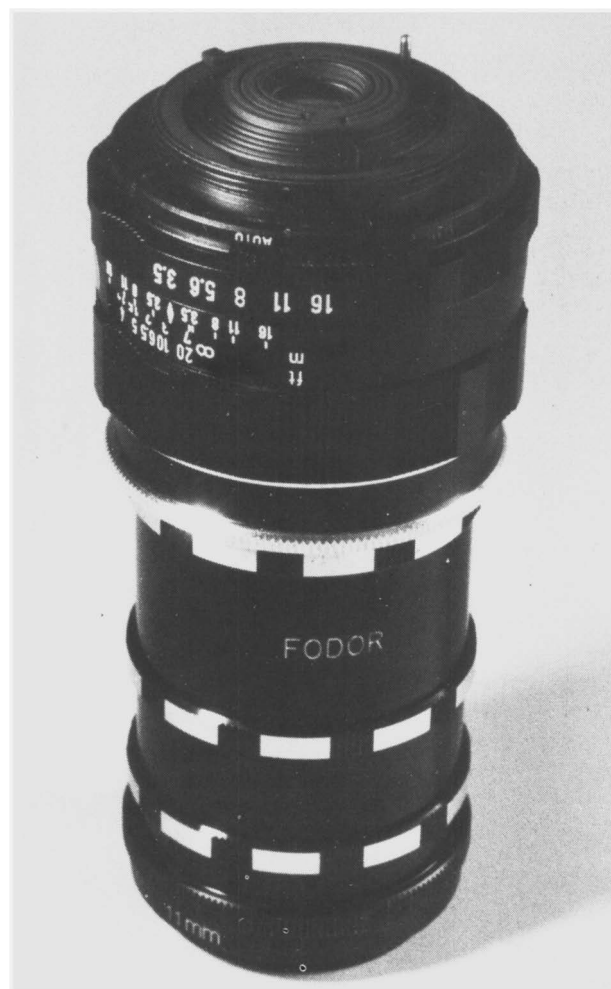
afb. 4. Door tussenkomst van de omkeerring kan het objectief achterstevoren op tussenringen of balg worden bevestigd. De achterlens wordt daardoor de frontlens.
