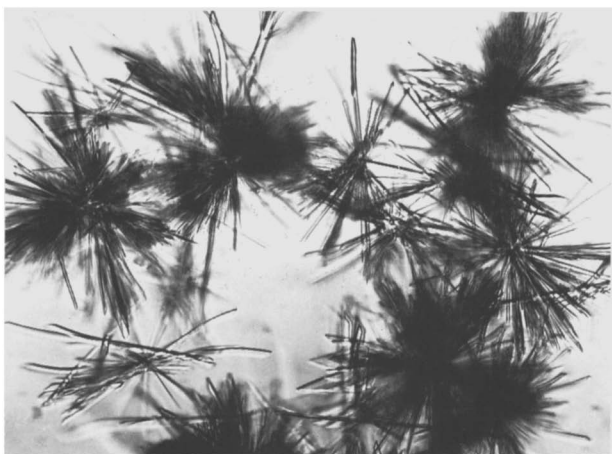
Afb. 6. Bij snelle kristallisatie ontstaan radiaalstralige aggregaten van naaldvormige kristallen, de zogenoemde "zeeëgels" van gips.
