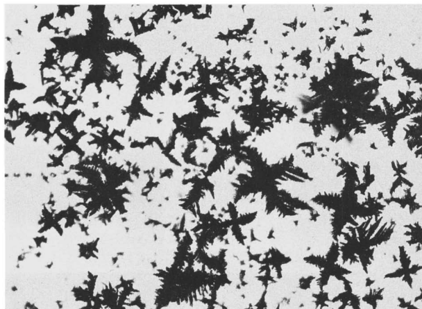
Afb. 8. Zinkproef. Dendritische kristallen van zink-mercuri-thiocyanide: Zn(CNS)_2 \cdot Hg(CNS)_2 .
