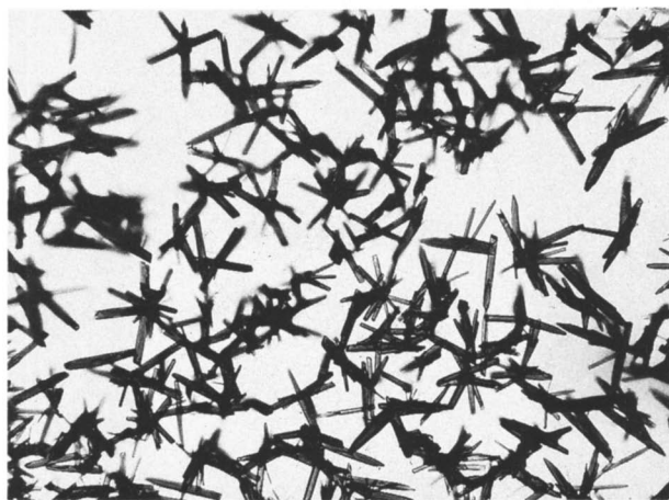
Afb. 9. Kobaltproef. Naaldvormige kristallen van kobaltmercuri-thiocyanide: \text{Co}(\text{CNS})_2 \cdot \text{Hg}(\text{CNS})_2 . Deze zijn blauw en doorzichtig.
