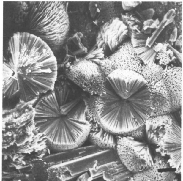
Afb. 11. Cacoxenietkogels, REM-opname, vergroting 160x. Diameter van de middelste bol is 0.16 mm
