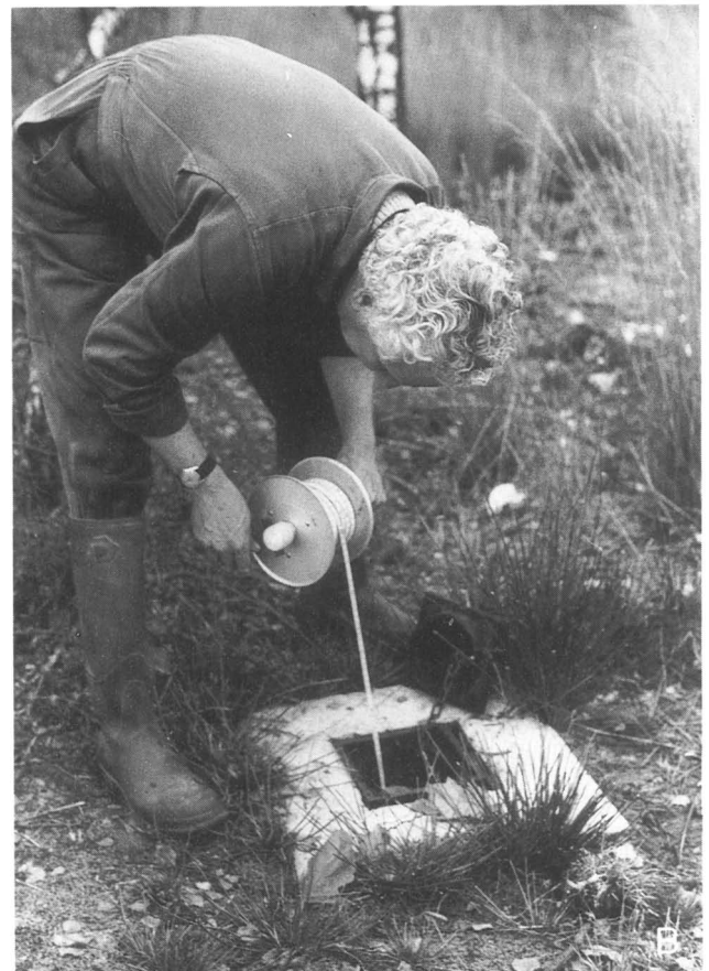
Afb. 3. Het opmeten van de waterstand in een piëzometer. Op foto 3A wordt de sonde getoond, die in de peilbuis zal worden neergelaten. Op foto 3B gaat het lichtje van het meetapparaat branden, zodra de sonde het wateroppervlak bereikt.
