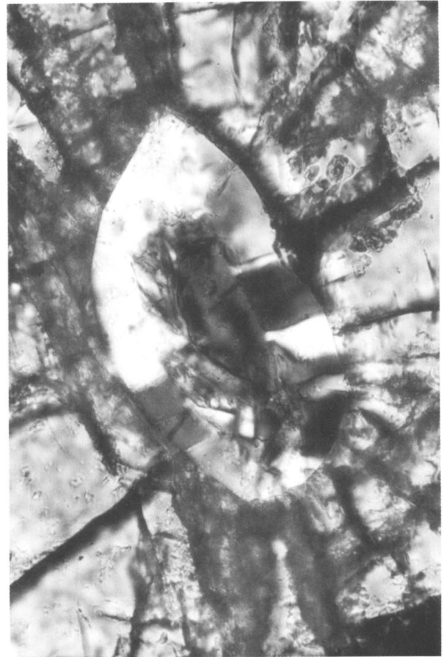
Afb. 4B. Vergrote en iets gedraaide weergave van hetzelfde insluitel, nu met gekruiste nicols: de rand van het insluitel bestaat uit radiaal gegroeide polykristallijne kwarts, de kern bestaat nog uit coesiet. Foto's: Yuexiang Cong.
