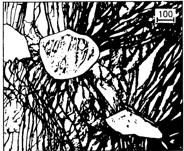
Afb. 3. Tekening naar een foto onder de polarisatie-microscopie van een slijpplaatje van pyroop uit de kwartsiet van Parigi, Dora Maira massief. De insluitels hebben een rand van kwarts, en bevatten in het midden resten van coesiet; rond de insluitels radiale barsten in pyroop door de toename van volume bij de omzetting van coesiet naar kwarts. Schaal = 100 micrometer. Naar C. Chopin (1984, p. 110, Fig. 3d).
