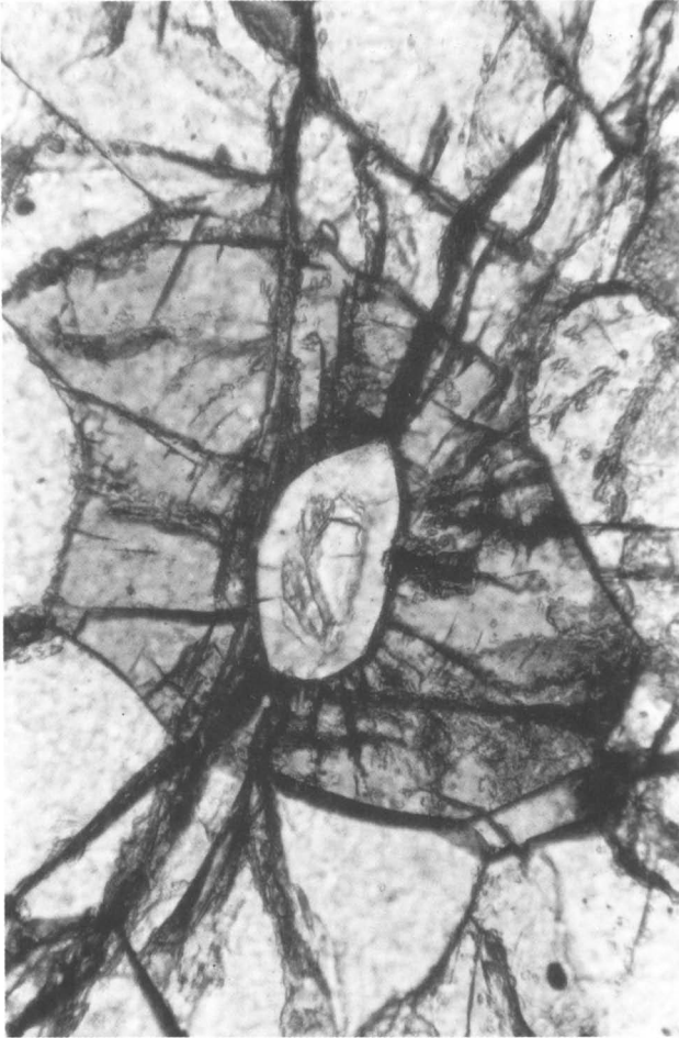
Afb. 4A. Coesietinsluitel in pyroxeen in eclogiet, Siwu, Anhui provincie, Oost-China; het insluitel is 0,2 mm lang en 0,1 mm breed; let op de radiale barsten in de pyroxeen. De lichtere korrels rond de pyroxeen zijn granaat.
