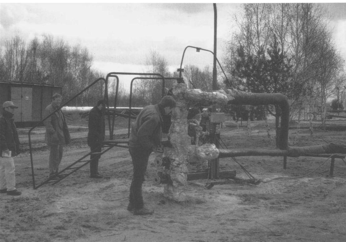
Afb. 8. Het ontginnen van zwavel met de Frash-methode, gebaseerd op het lage smeltpunt van zwavel. Heet water gaat het boorgat in, vloeibaar zwavel komt eruit. Jeziórko-mijn bij Tarnobrzeg, Polen. Foto: Bas Bossers.
