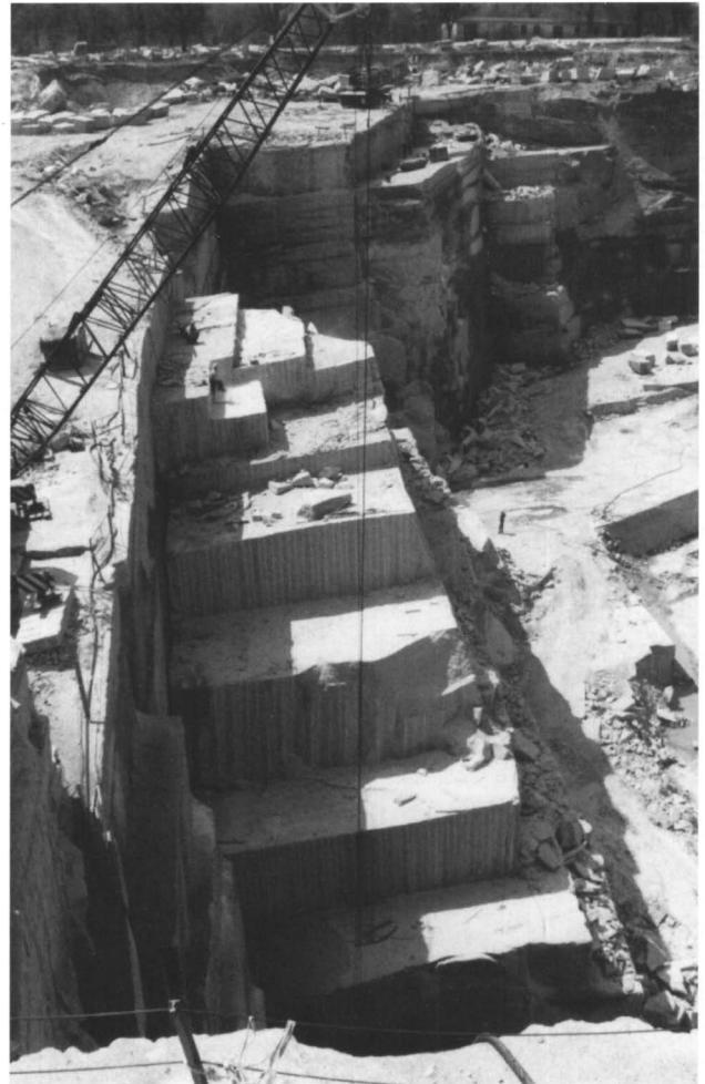
Afb. 1. De Strzegom-graniet wordt al in de groeve tot blokjes verwerkt. Foto: Koen Hos.
