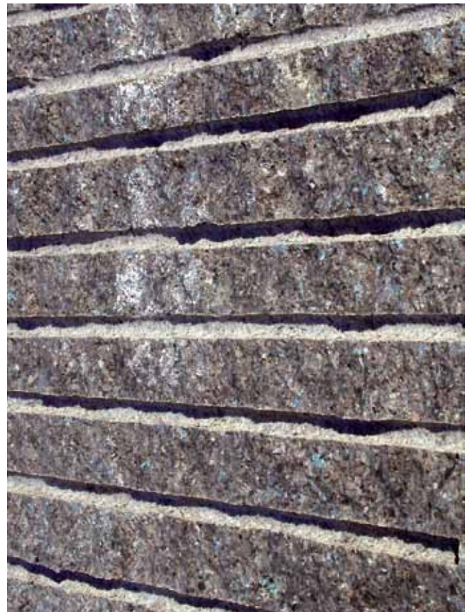
Afb. 2. Anorthosiet uit de Dimension Stone Quarry te Hellvik met boorgaten voor de exploitatie. De labradorisering (het blauw oplichten van de plagioklaaskristallen) is goed te zien.
