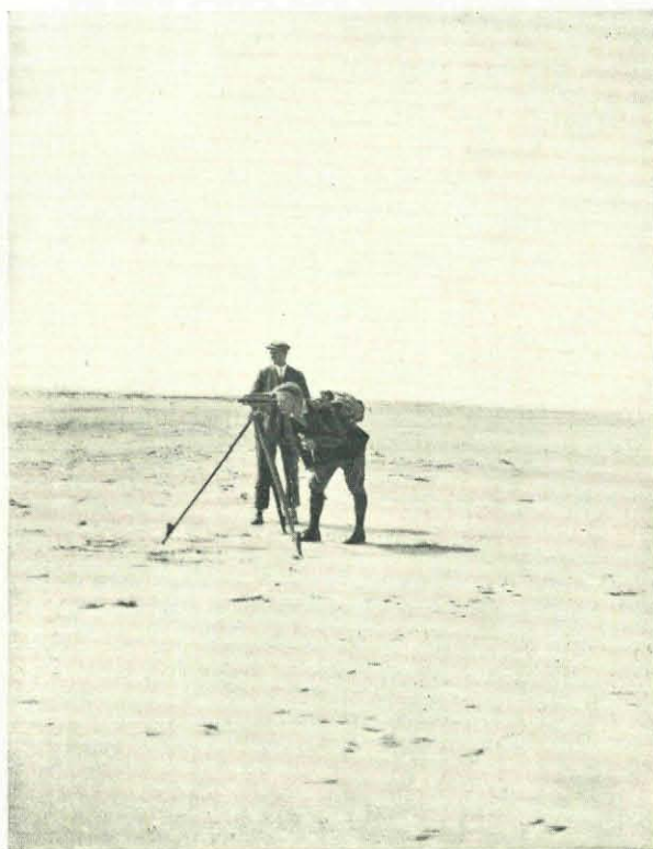
Fig. 4. Het waterpassen van de hoogte van den water-spiegel van het Breede Water.
