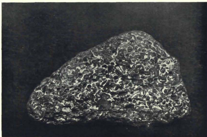
Fig. 3. Kiezeroöliet van Amersfoort, met veel graankorrelvormige en kokervormige oöieden en fossieltjes van lagere organismen. Vergr. 2 × lin., foto van Schr.
