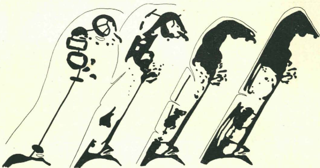
Fig. 5. Hoe met stuifdijken van een kaal strand een rijk natuurreservaat werd gemaakt. Van l. naar r.: de toestand kort na de aanleg van de Zanddijk (1629—30); de toestand bij het begin van de negentiende eeuw (wandeland over de Zanddijk zag je toen links een breed strand en rechts een enorm gebied van schorren en krekens); kort na de doorbraak (1858) van de afsluitdijk van 1855; de huidige situatie.
