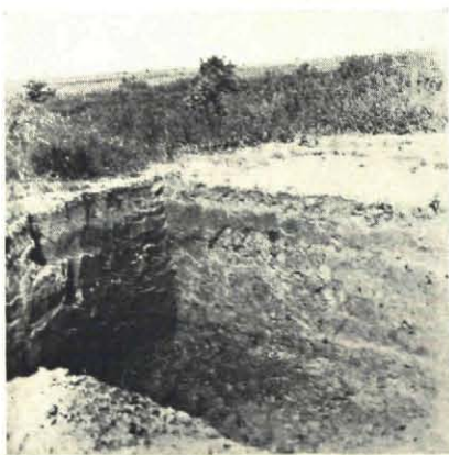
Fig. 2. Een „leemdobbe”. Ongeveer drie meter diep graaft men het keileem weg, om er schuurdelen mee te bepleisteren. Onderaan zit het beste blauwe leem.
