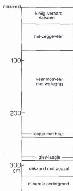
Fig. 2. Bodemprofiel onder het Friesche Veengebied (boring W. Molenaar). Soil profile of the Friesche Veengebied.
