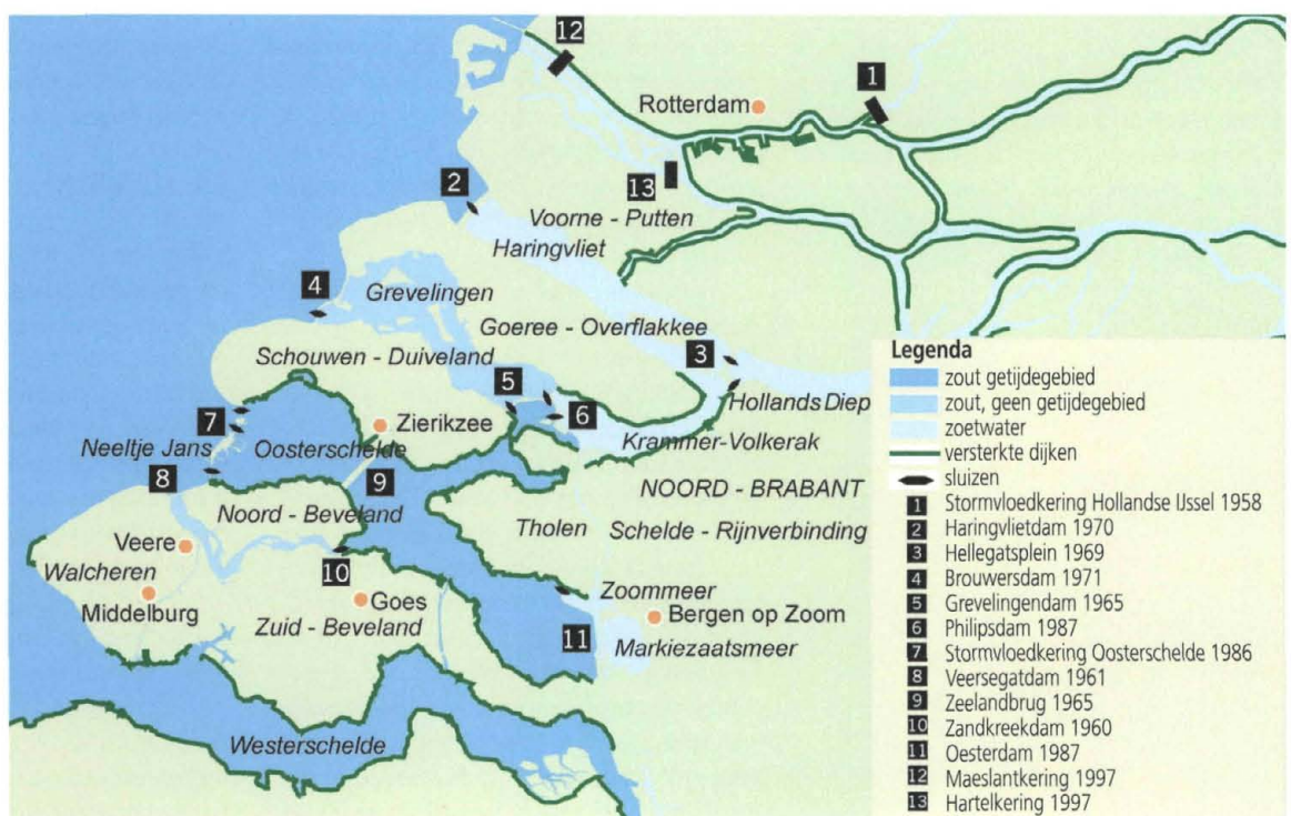
Fig. 1. Overzicht van de huidige deltawateren en uitgevoerde deltadammen van het Deltaplan. In de oorspronkelijke plannen zouden achter de dammen grote zoetwatermeren ontstaan, die onder andere dienst zouden gaan doen als bron van zoetwater voor de landbouw. De Oosterschelde zou dan omgedoopt worden in het Zeeuwse Meer.
