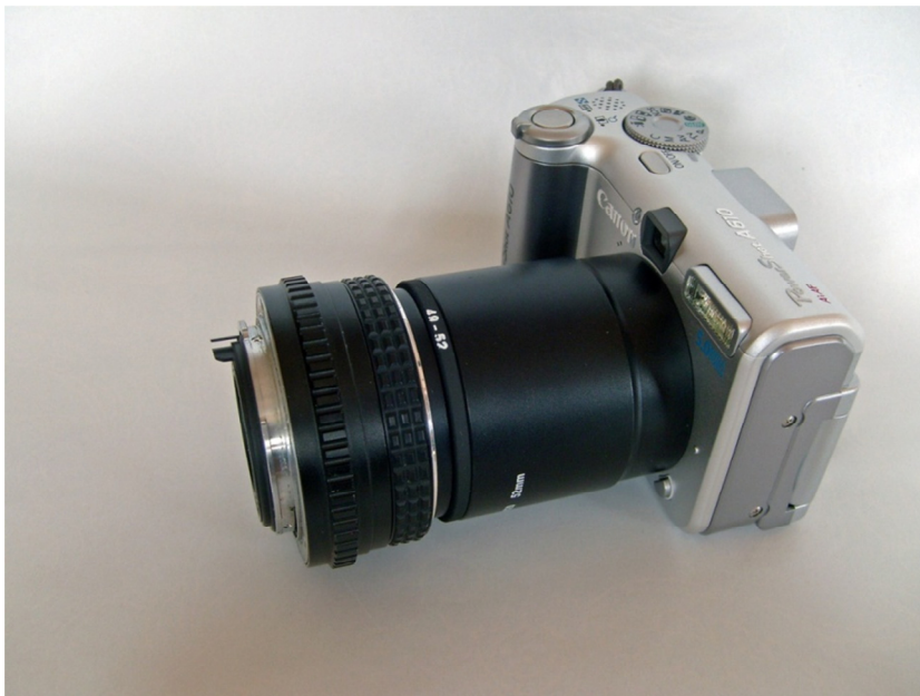
Figuur 23. Compactcamera (Canon powershot A610) met een adaptertubus, omkeering en een omgekeerd 50 mm objectief van een oude spiegelreflexcamera voor supermacro.
