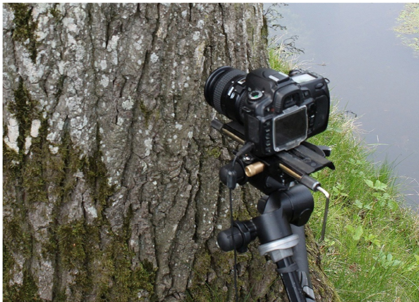
Figuur 4. Spiegelreflexcamera met speciale macrolens op statief met een instelslede voor zeer precieze scherpstelling.
