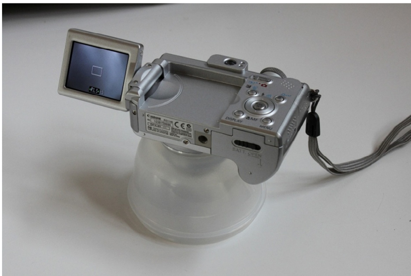
Figuur 6. Compactcamera met als steun een omgekeerd plastic schaalpje waar de bodem uit gehaald is en welke als een minifotostudio gebruikt kan worden voor foto's van mossen en korstmossen op vlak substraat.
