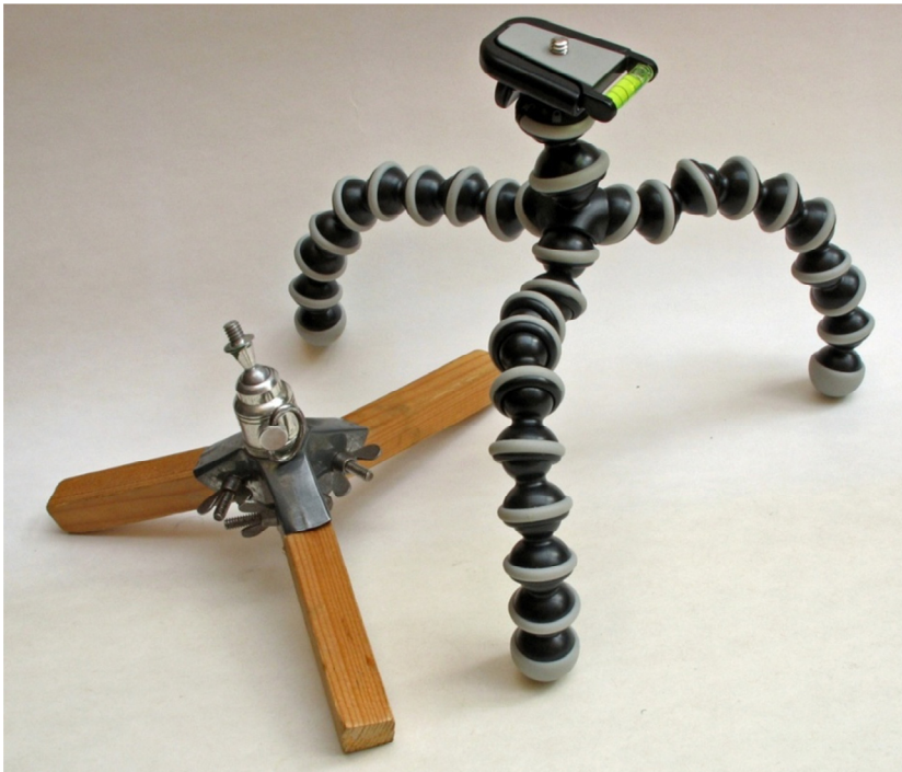
Figuur 5. Voorbeelden van kleine lichtgewicht statiefjes handig voor compactcamera's. Links een zelfbouw gemaakt van een gerecycled statiefkopje, een deksel van een blikje en drie houten pootjes en vleugelmoeien. Rechts de gorillapod van Joby die op allerlei ongelijke oppervlakken kan worden gebruikt en zelfs op takken bevestigd kan worden (zie fig. 3).
