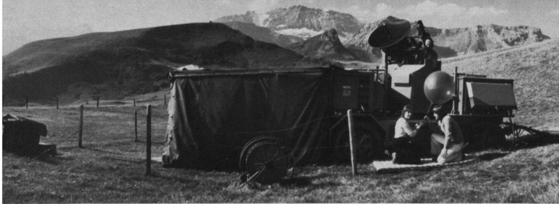
Afb. 2. Voorbereiding van een windmeting met het radarapparaat 'Superfledermaus' op de Hahnenmoospas. Gezien naar het ZO, loodrecht op de belangrijkste trekrichting. Foto: Christian Perret.
