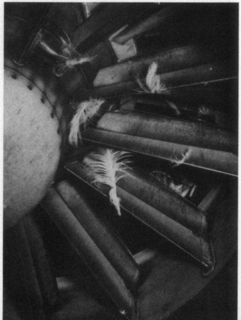
Buizerd in de compressor van een NF5-motor: opgeslurpt op 19 november 1979 boven Duitsland.
