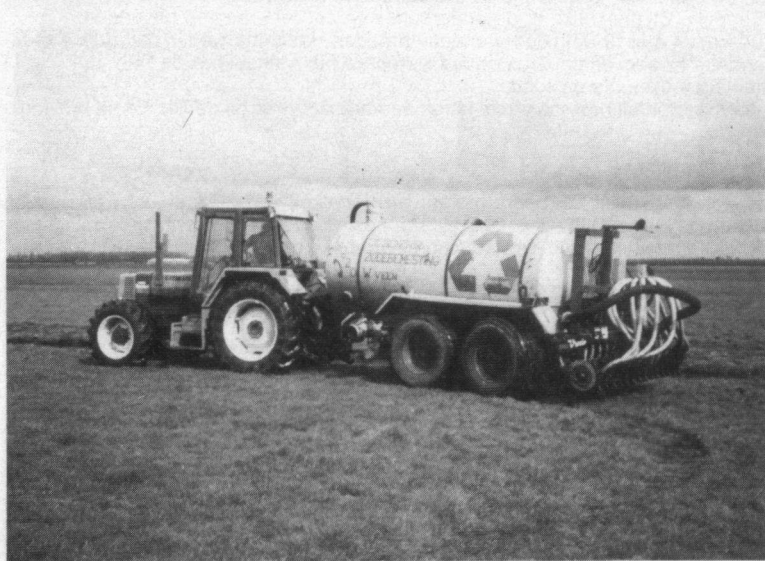
Deze zodebemester injecteert de mest op een diepte van acht centimeter in de bodem. Foto: Ko Katsman.
