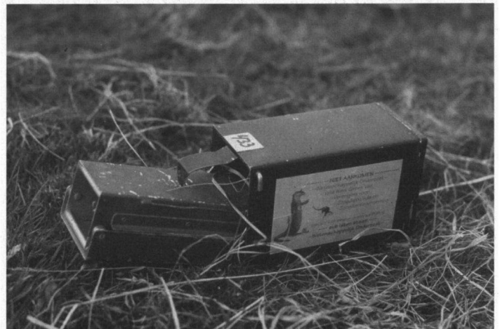
Een 'Longworth-inloopval', een inloopval waarmee muizen levend gevangen en weer vrij gelaten worden. foto: Sietske Rintjema
