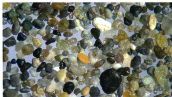
Afbeelding 2. Zware fractie afkomstig uit duinzand met een dichtheid van hoger dan 2,65 \text{ g/cm}^3 en een gemiddelde korrelgrootte van \pm 0,2 mm.
