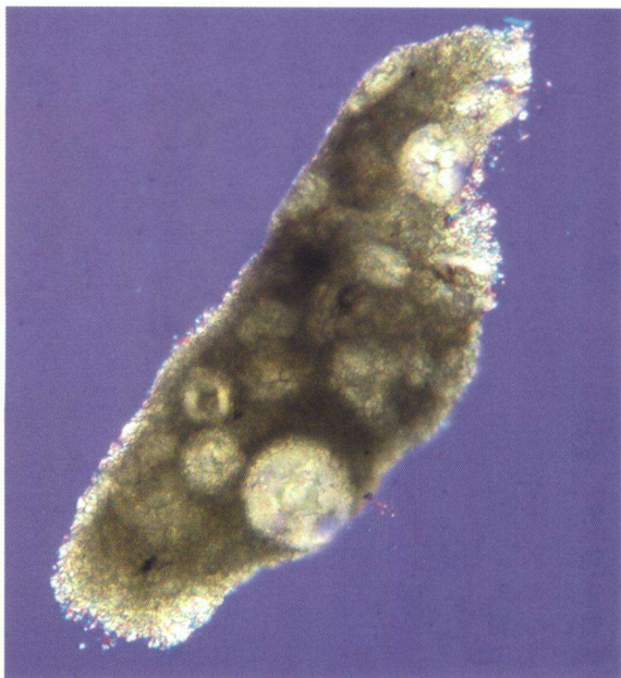
Afbeelding 3. Kalksteenkorrel met microfossielen (max. diam.: 0,19 mm polarisatiemicros- coop met X-nicols).
