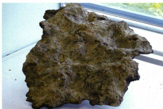
Afbeelding 3. De onderzijde van de kalk-ijzeroerconcretie. Het oppervlak vertoont een bultvormig microgeomorfologisch patroon.
