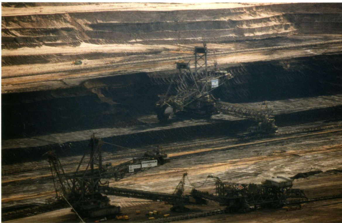
Afbeelding 6. Bruinkool en enorme graaf- machines in Tagebau Hambach. Het waas op de foto wordt veroorzaakt door stof dat bij de werkzaamheden vrijkomt.
