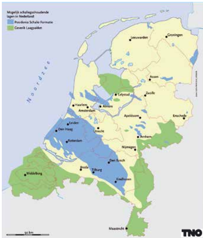
Afb. 3. Voorkomen van Nederlandse schaliegasformaties: de Posidonia Schalie (blauw) en het Geverik Laagpakket (groen) tot een diepte van 4500 meter.
