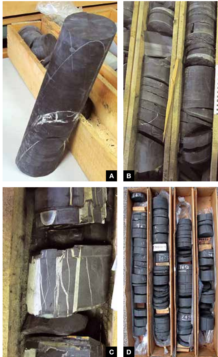
Afb. 4. Boorkernen van het Geverik Laagpakket: a) gesteentekern van donkere schalie met gerekrystalliseerde diaklazen in wit; b) kernen met klei (zwart) en zandigere lagen (grijs); c) close-up van Geverik-kern met enkele verticale diaklazen; d) vergelijking met de Amerikaanse schalieformatie Marcellus shale. In opname c is goed te zien hoe de diaklazen (wit) beïnvloed worden door de meer zandige laag halverwege de kern, om vervolgens in dezelfde richting door te gaan.
