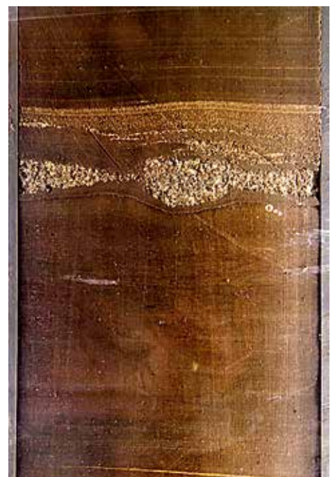
Afb. 6. Foto van een interval in de gelamineerde kleischalie (Messel Formatie) uit de boorkern (Ø 10 cm) met een grofklastische tussenlaag, waarschijnlijk als gevolg van bijzonder zware neerslag.
