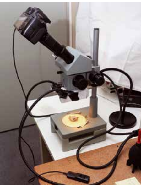
Afb. E. Testopstelling BM-stereomicroscop met camera op één tubus geplaatst.
