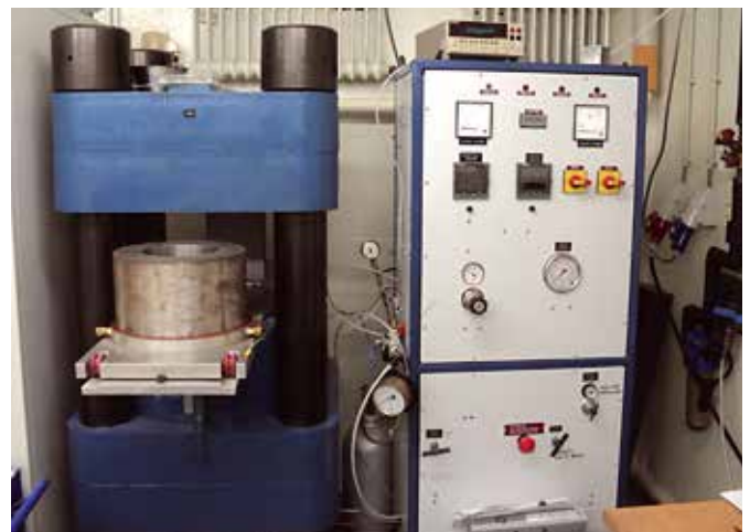
Afb. 6. Het Multi-Anvil-apparaat in de kelder van de Vrije Universiteit Amsterdam.
