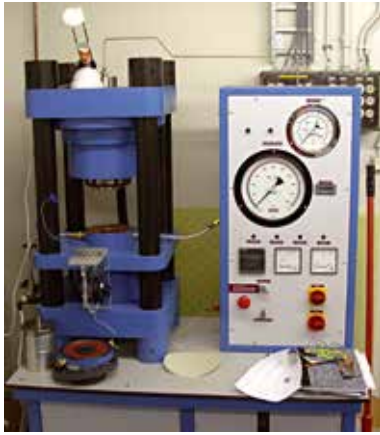
Afb. 7. Het Piston-Cylinder-apparaat in de kelder van de Vrije Universiteit Amsterdam.
