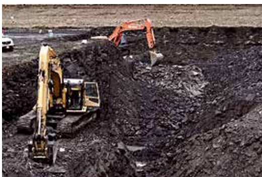
Afb. 2. Ontginning van de ammonietenrijke schalie van de Bearpaw-Formatie in een mijn van Korite. Foto: Korite International Ltd.
