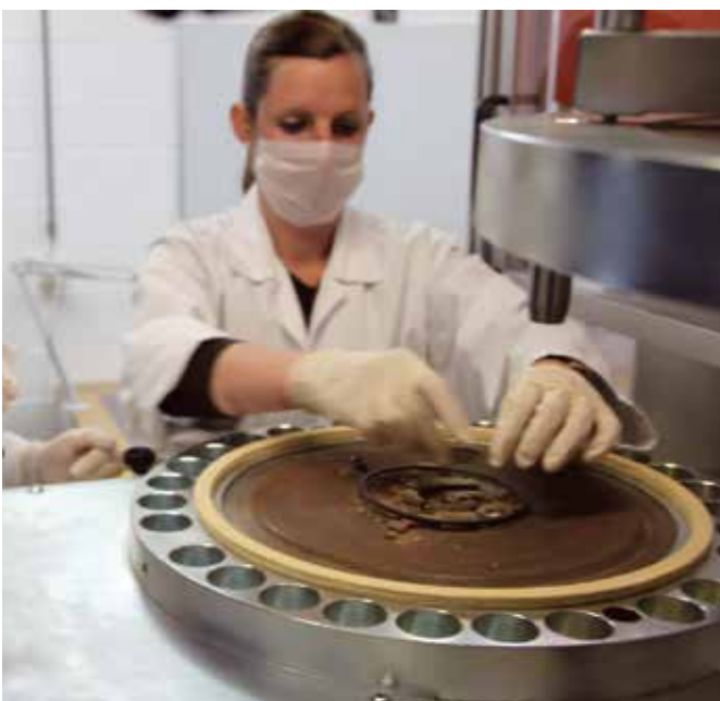
Afb. 4. Apparatuur met groeicellen waarin de koolstof uit de as verder wordt gezuiverd.
