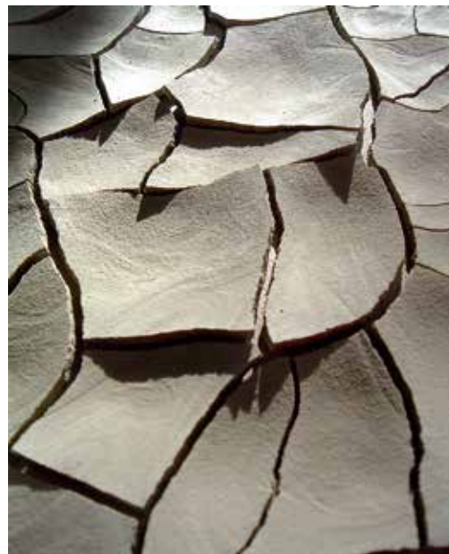
Afb. 4. Opgedroogde smectiet met krimp-scheuren en iets oprullende randen.
