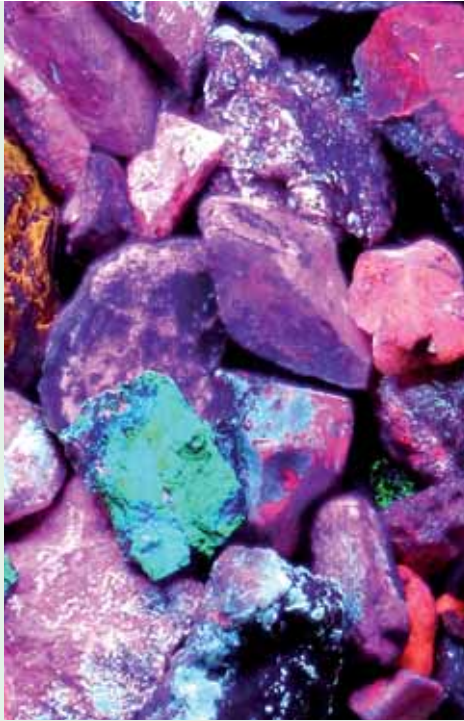
Foto 6. Fluorescentie van bodem-mineralen onder kortgolvig UV, bodemmateriaal van de Casino Weiher Halde te Kelmis.
