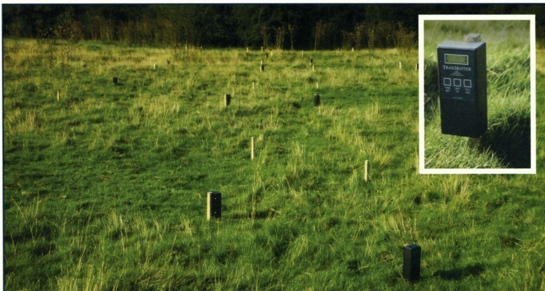
Foto 3. Trailmaster kastje (inzet) en veldopstelling trailmasters. Het Trailmaster kastje zendt een infrarood straal uit vanuit het 'oog' aan de zijkant van de kast. Dit signaal wordt opgevangen door een ontvanger. De Trailmaster registreert onderbrekingen van deze straal, zoals gebeurt wanneer een konijn ervoor zit. We hadden de Trailmasters zo opgesteld dat ze straalonderbrekingen diagonaal over een plot meten. Foto: Liesbeth Bakker.
