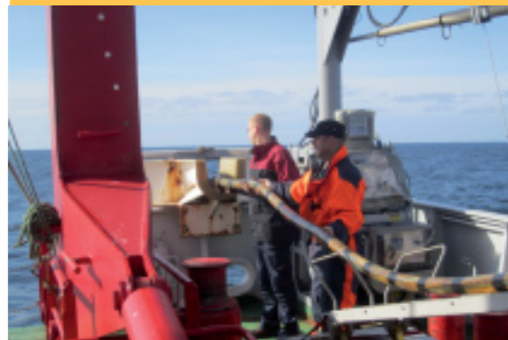
Het uitrollen van de slang met hydrofoons (onderdeel van het Delphinus-systeem). Foto Frans-Peter Lam
