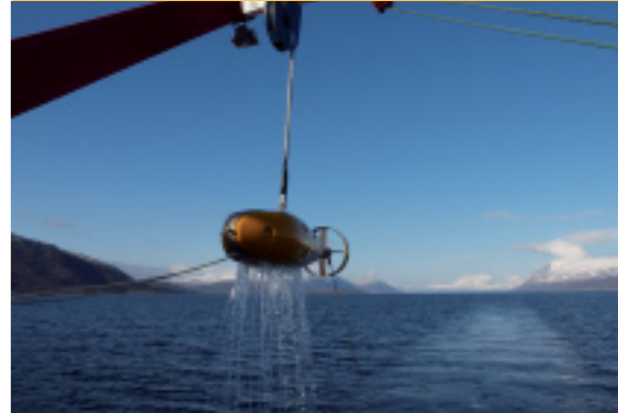
De Socrates sonarbron als hij uit het water wordt gehaald achter het schip en weer aan dek wordt gezet na gebruik. Tijdens gebruik van de sonar wordt de gele vis door het water gesleept op ca 60m diepte. Foto René Dekeling
