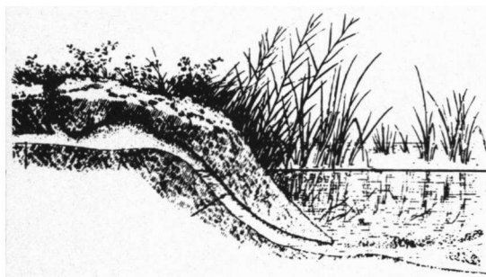
Afbeelding 6. Doorsnede van een hol van een Muskusrat in een oeverkant.
