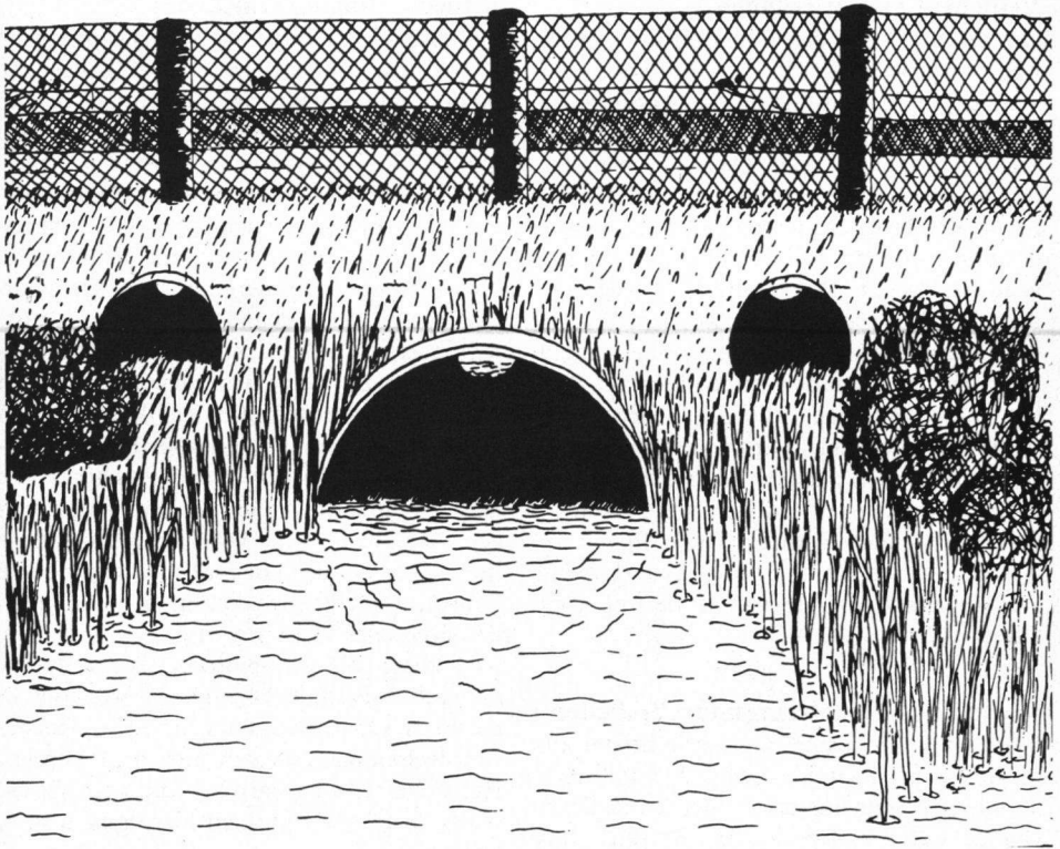
Figuur 4. Schets van (otter)tunnels met geleidende vegetatie en rasters bij een duiker.
