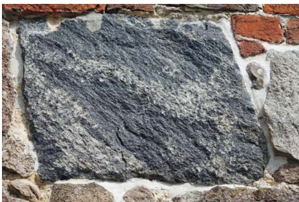
AFBEELDING 6. | Hoornblendegneis. Het zwartgrijze gesteente is door zijn parallelle streping duidelijk als een metamorf gesteente te herkennen. Het zwarte mineraal is hoornblende. De splijtvlakjes van de hoornblendekristallen op het breukvlak schitteren in het zonlicht.
