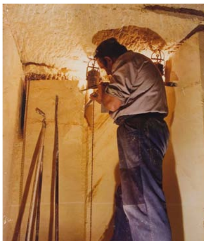
AFBEELDING 3. | Hedendaagse ondergrondse mergelwinning in de Sibbergroeve: de mergelbreker of blokbreker. Foto: Firma Kleijnen, Sibbe.
