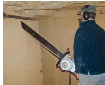
AFBEELDING 4. | Hedendaagse ondergrondse mergelwinning in de Sibbergroeve: langs de zaagsnede. Foto: Firma Kleijnen, Sibbe.
